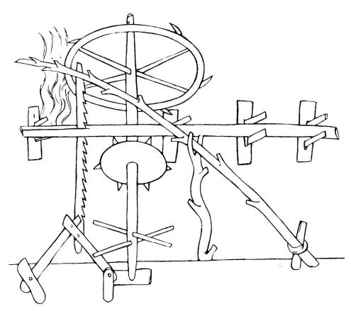
↑ Wassergetriebenes Sägewerk aus dem Bauhüttenbuch von Villard de Honnecourt (ca. 1230-35).
