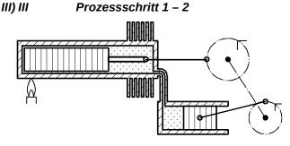
Der AK komprimiert die Wärme abgebende Luft isotherm. Die aufgewendete Kompressionsarbeit muss geringer sein als die gewonnene Expansionsarbeit......
