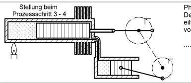
Phasenverschiebung: Der Verdrängerkolben eilt dem Arbeitskolben voraus, und zwar um
