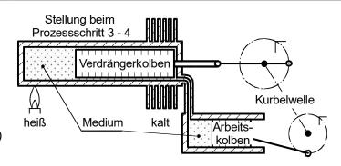
Phasenverschiebung: Der Verdrängerkolben eilt dem Arbeitskolben voraus, und zwar um
