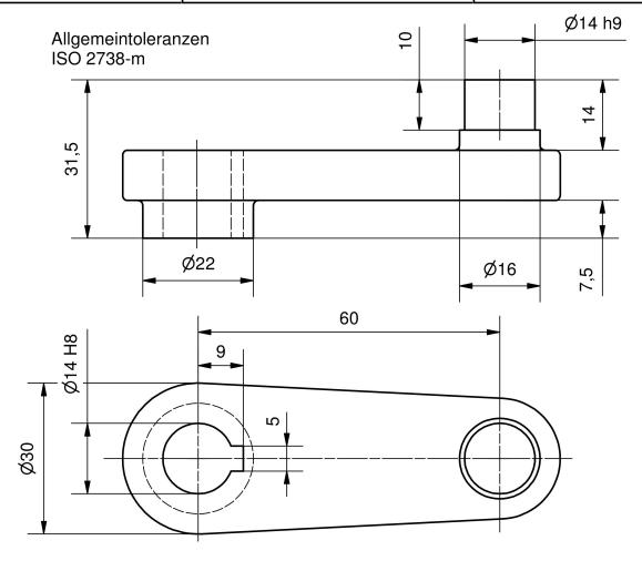
Ergänzen Sie den Prüfmittelplan für die dargestellte Kurbel unter Verwendung herkömmlicher Prüfmittel.
