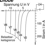
Dargestellt sind die Kennlinien mehrerer Z-Dioden, z.B. V4 oder V6. Man erkennt, dass die Z-Diode V6 bis zur Durchbruchspannung  $U_Z = 8V$  keinen Strom durchlässt. Über der Durchbruchspannung steigt der Strom durch die Z-Diode stark an - wie bei einem Überlauf.
