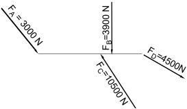
Maximales Biegemoment M<sub>bmax</sub> = 5,71 kNm (das Größere)
